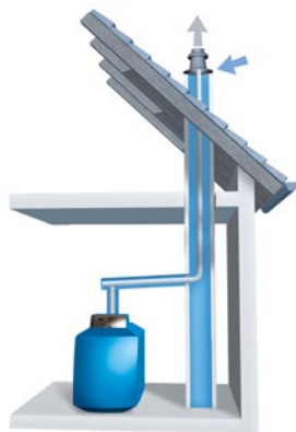
Raumluftunabhängige Aufstellvariante mit eingezogener Kunststoff-Abgasleitung im Schornstein.
