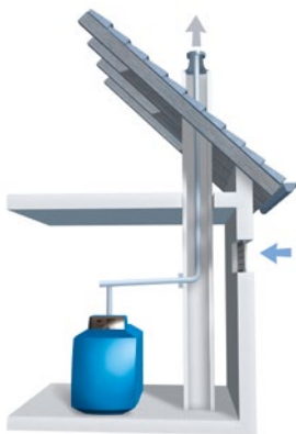
Raumluftabhängige Aufstellvariante mit eingezogenem Abgasrohr im Schornstein.
