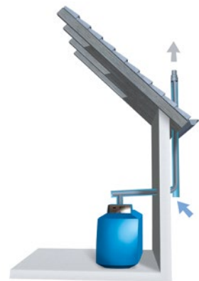
Raumluftunabhängige Aufstellvariante mit Rohr-in-Rohr-Kunststoff-Abgassystem entlang der Aussenfassade.
